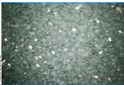
Photo 4 En l'absence de Soleil, les particules de miroir deviennent des granulats blancs In the absence of sunshine, the mirror particles become white aggregates
